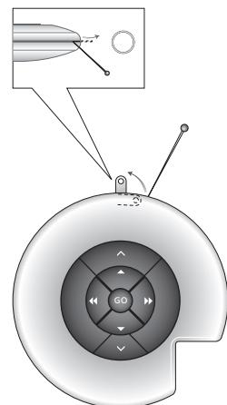
Använd en nål för att dra ut nyckelringsfästet. Du kan till exempel använda det för att fästa en halsrem.
