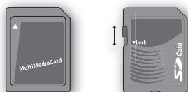
*Det finns en mängd leverantörer av MultiMedia-kort (MMC) och Secure Digital-kort (SD). Minneskort från SanDisk har testats och godkänts för att användas med BeoSound 2. Du kan skrivskydda ett SD-kort genom att dra ned reglaget.*
