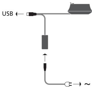
Подсоедините кабель *USB cable* – если Вы пользуетесь ПК, ждите появления на экране специальной инструкции о его подсоединении.
