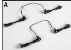
2. Montieren Sie die Verbindungen des vorderen Stabilisators in dem Loch am vorderen Querlenker, das dem Chassis am nächsten ist (nach vorne) (B). Setzen Sie den Stabilisator in den Einschnitt, der sich auf dem Chassis direkt hinter dem Stoßdämpfergehäuse befindet. Drehen Sie die beiliegenden 3 x 6 mm Flachkopfschrauben in die Löcher (C), bis Sie den Stabilisator berühren und lösen Sie sie dann wieder leicht.
