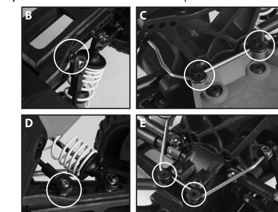
3. Instale los acoplamientos desde la barra estabilizadora trasera en el orificio más cercano al chasis en el brazo de suspensión trasero (hacia el frente) (D). Inserte la barra estabilizadora en la ranura ubicada en la estructura del paragolpes trasero. Atornille los tornillos incluidos de cabeza plana de 3 x 6 mm en los orificios (E) hasta que toquen la barra y luego aflojelos ligeramente.
