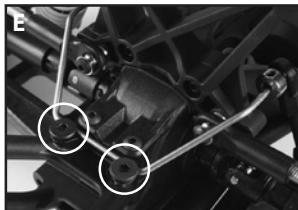
3. Montieren Sie die Verbindungen des hinteren Stabilisators in dem Loch am hinteren Querlenker, das dem Chassis am nächsten ist (nach vorne) (D). Setzen Sie den Stabilisator in den Einschnitt, der sich auf der hinteren Stoßstangenhalterung befindet. Drehen Sie
