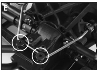
3. Installez les biellettes de la barre de direction arrière dans le trou le plus proche du châssis, dans le bras de suspension arrière (vers l'avant) (D). Fixez la barre de direction dans la cannelure située sur le support de pare-chocs arrière. Filetez les vis à tête plate de
