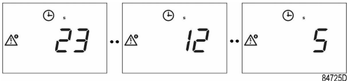
Exempel på nedräkningstid för fördröjning av automatisk återstart efter spänningsfel.
