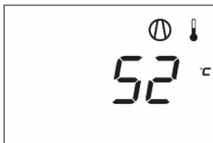
Huvudskärm med temperatur (stoppad kompressor)
