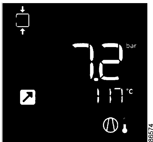
Figur 23. Huvudskärm med avstängning på grund av utloppstemperatur
