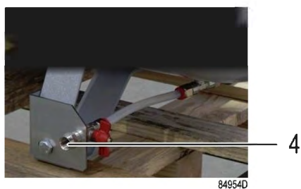
Figur 57. Kondensatavtappningsventil på luftbehållare
