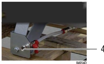
Figur 43. Kondensatavtappningsventil på luftbehållare
