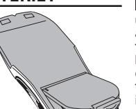
Sätt in ett nytt 9V batteri. Var noga med att passa in plus (+) och minus (-) polerna enligt ikonerna på baksidan. Snäp fast batteriet och stäng luckan.
