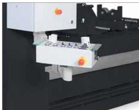
PANNELLO COMANDI CON DISPLAY SIEMENS
