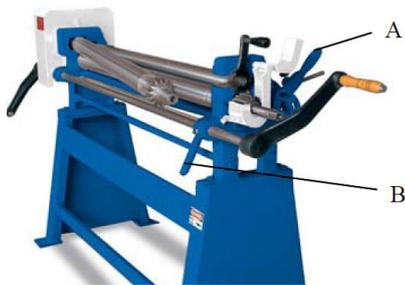
Abb. 10: Bedienhebel zur Bewegung der Walzen
