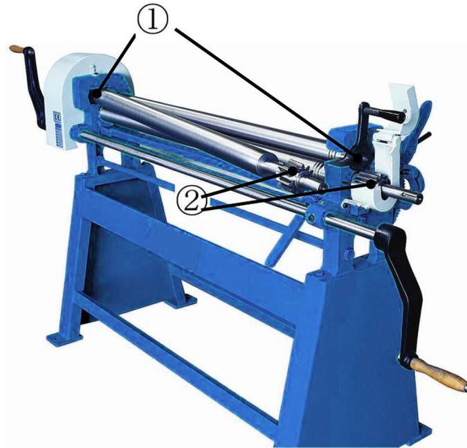
Abb. 16: Zu schmierende Stellen an der Rundbiegemaschine
