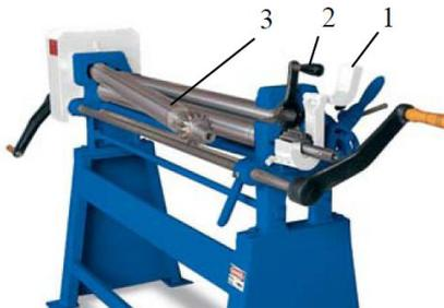
Abb. 13: Oberwalze ausklappen
