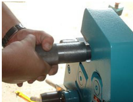
Abb. 14: Verriegelung der Oberwalze lösen
