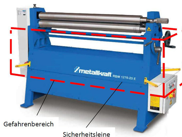
Abb. 9: Gefahrenbereich an der Rundbiegemaschine
