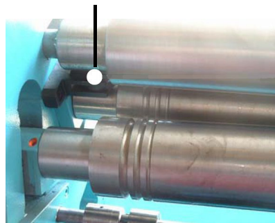
Abb. 17: Konisch Biegen: Werkzeug (links) und Kupplungen (rechts)
