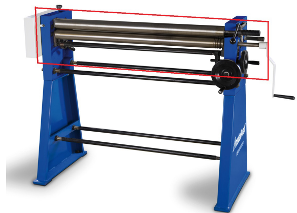
Abb. 8: Gefahrenbereich an der Rundbiegemaschine
