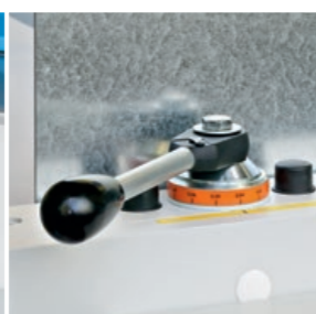
Mellanrumsinställning justeras utan verktyg
