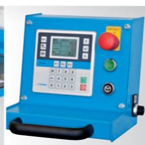
Programmerbar skärstyrning och databas för skärprofiler och skärförlopp (styrningsvariant NC)
