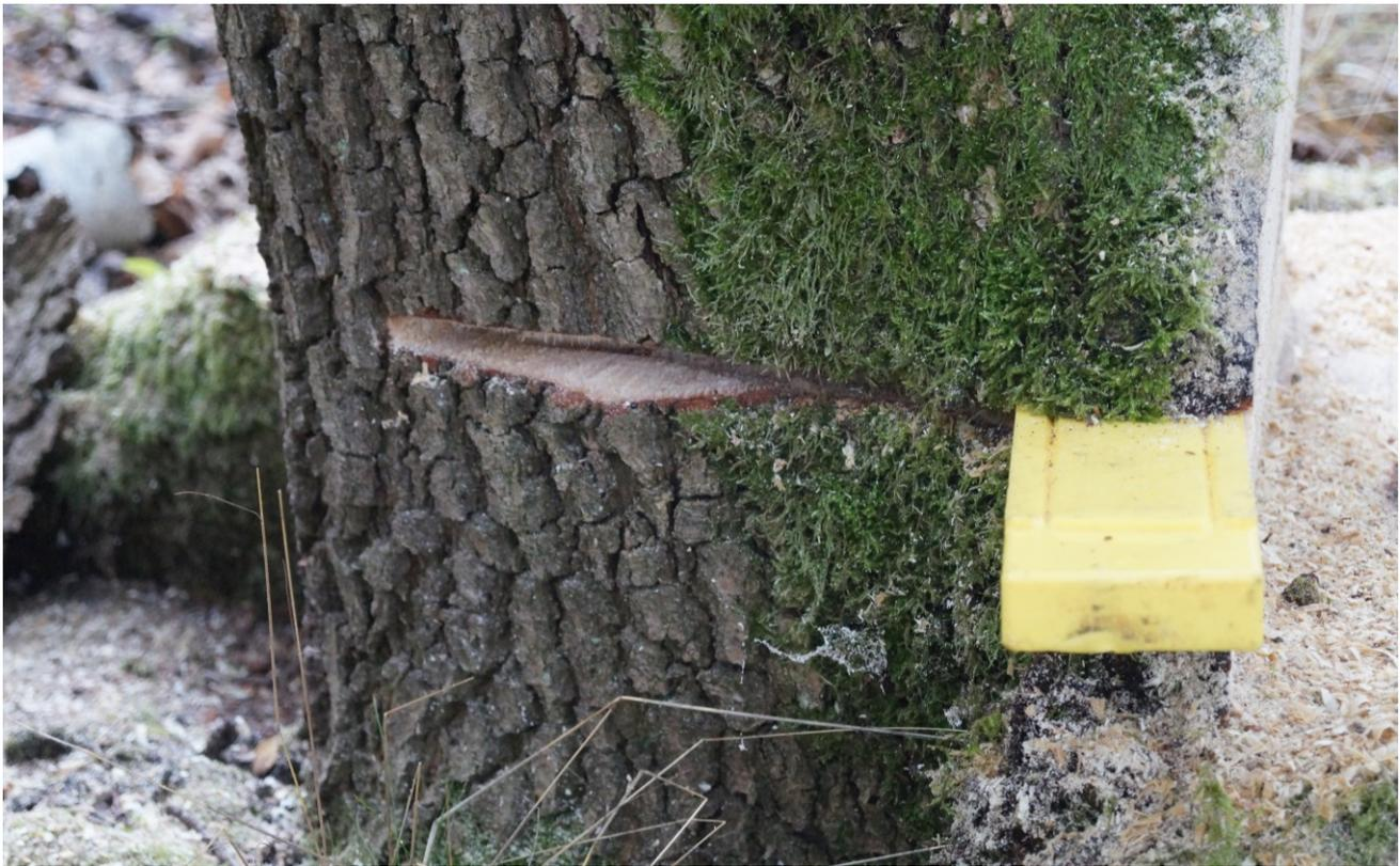
**Abb. 6: Fällschnitt keilförmig für EDER Fällkeil Titan 80 erweitern (Achten Sie auf eine symmetrische Form)**
