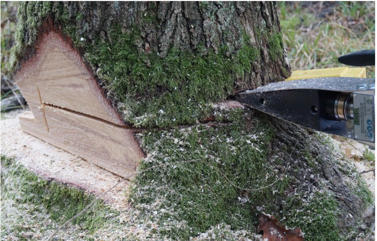
**Abb.8: Versetzten Fällschnitt durchführen**
