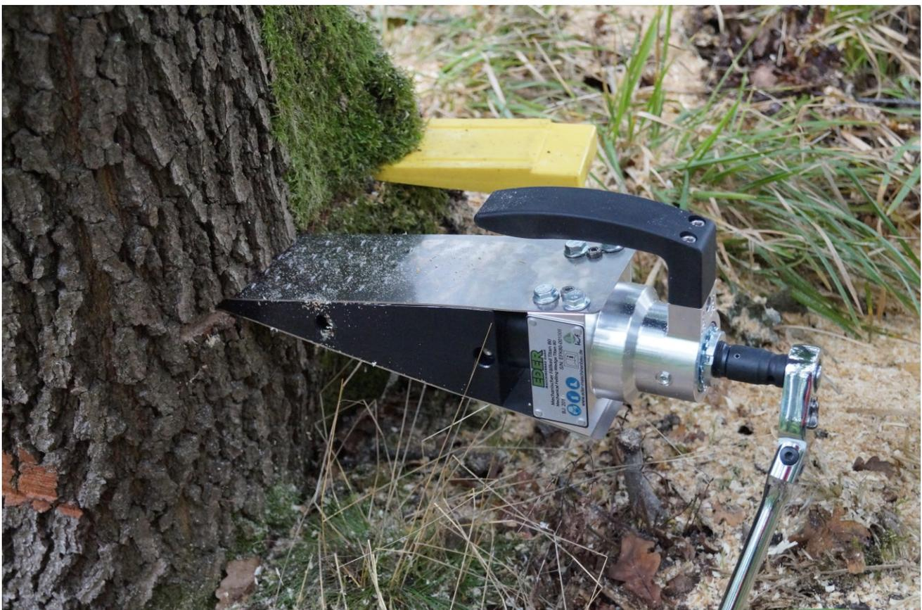
**Abb.7: EDER Fällkeil Titan 80 setzen (bis zur 6. Zahnreihe)**
