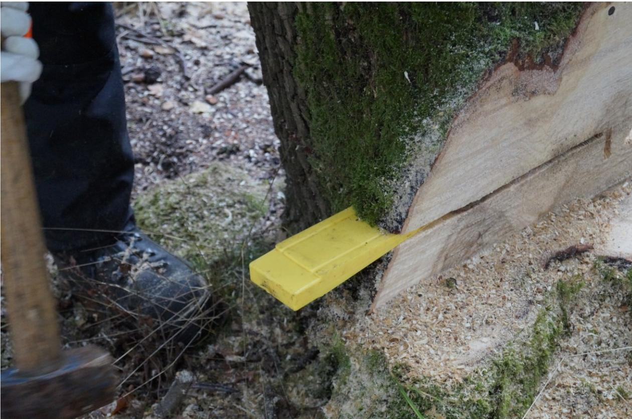
**Abb. 5: Sicherheitskeil aus Aluminium oder Kunststoff setzen**
