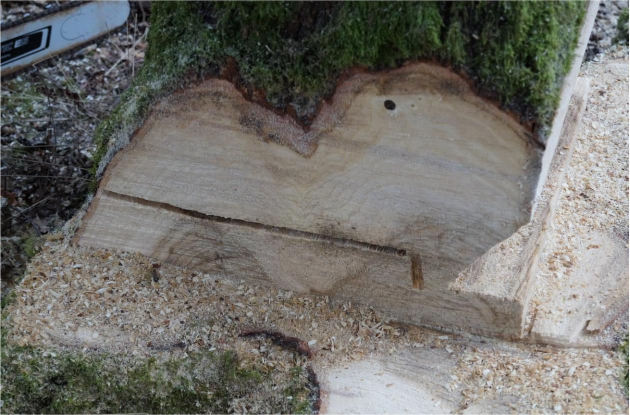
**Abb. 4: Fällschnitt zu 2/3 durchführen**
