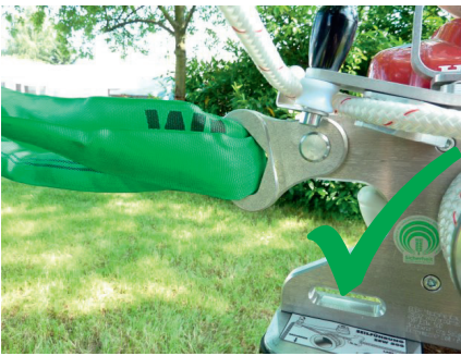
Abb. 7: Richtige Befestigung der EDER Powerwinch
