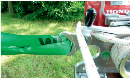
Abb. 5: Seilführung durch die Seilklemme
