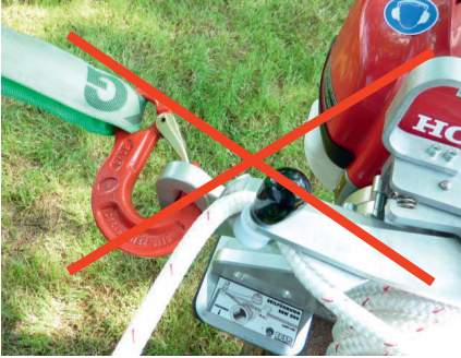
Abb. 6: Falsche Befestigung der EDER Powerwinch
