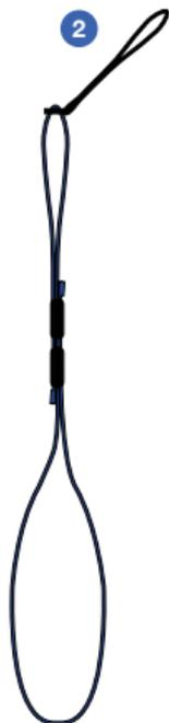
Pour le réglage, réduire ou agrandir la sangle bleue dans la boucle de réglage et maintenir la position avec les élastiques noirs.
