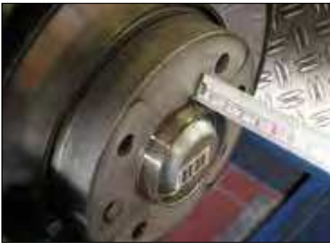
Länge der Radnabe hier 11mm (Beispiel)/ Length of wheel hub 11mm (example)
