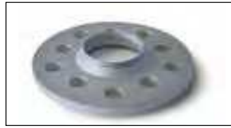
Artikel-Nr. / Part-no. 1655573, 1655577: Radnabenlänge max. 12 mm. Felgeninnenfase mind. 6x45° Wheel hub length max. 12 mm. Inner bavel 6x45°
