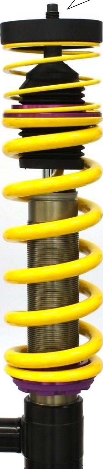
Originale Stützlagereinheit ohne Gummiunterlage auf den Federteller aufsetzen und mit der mitgelieferten Mutter verschrauben. Das Anzugsdrehmoment der Kolbenstangenbefestigung beträgt 50 Nm. Die Montagehinweise zum Einbau des Federbeines in das Fahrzeug, sowie die Anzugsdrehmomente der Federbeinbefestigung, entnehmen Sie bitte den Unterlagen des Fahrzeugherstellers.
