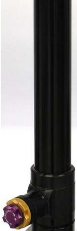
Bei Dämpferausführungen mit Druckausgleichsbehälter ist dieser zur Fahrzeugvorderseite innen zu montieren.
