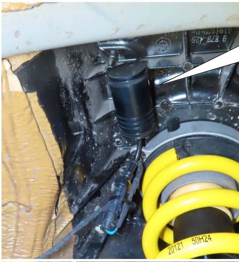
HA Stillegung einstecken und mit Edge Clips an der Kante am Fahrzeugdome befestigen. Auf die korrekte Verriegelung des Steckers achten! Leitung und Steckerverbindung mit einem Kabelbinder fixieren.
