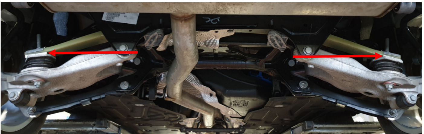
Abb. 1: Abstandskörper/Distanzstücke der Querblattfeder
