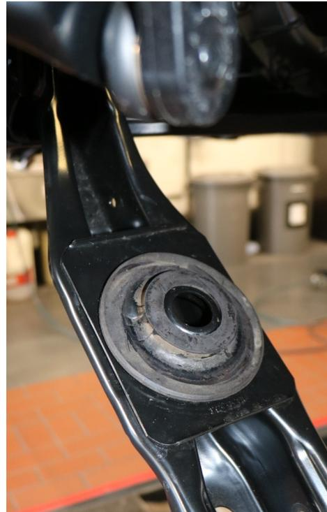
**Abb. 2:** Das Federgummi ersetzt das Federschloss
