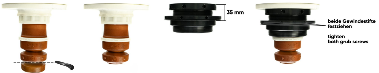
Abb. 3: HA Puffer kürzen / Definition Einstellmaß / Einbausituation
