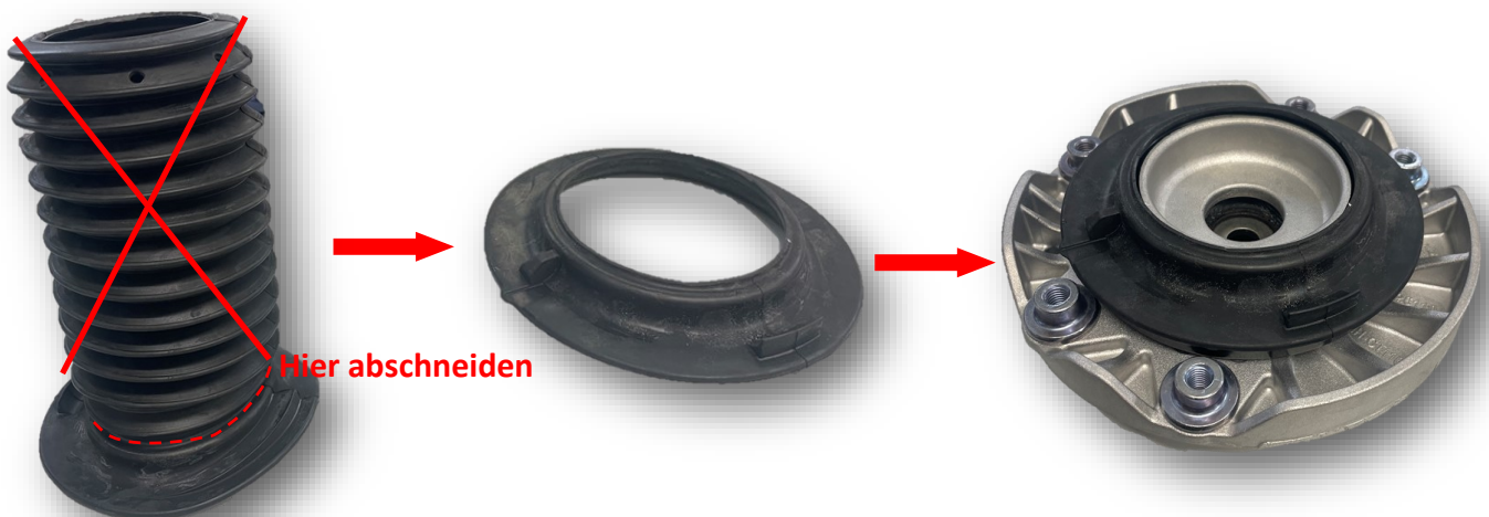
Abb. 1: Montage Federauflage (Abbildung ähnlich)
