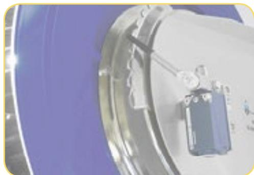
Microswitch di partenza automatica della turbina tramite srotolamento della tubazione.
