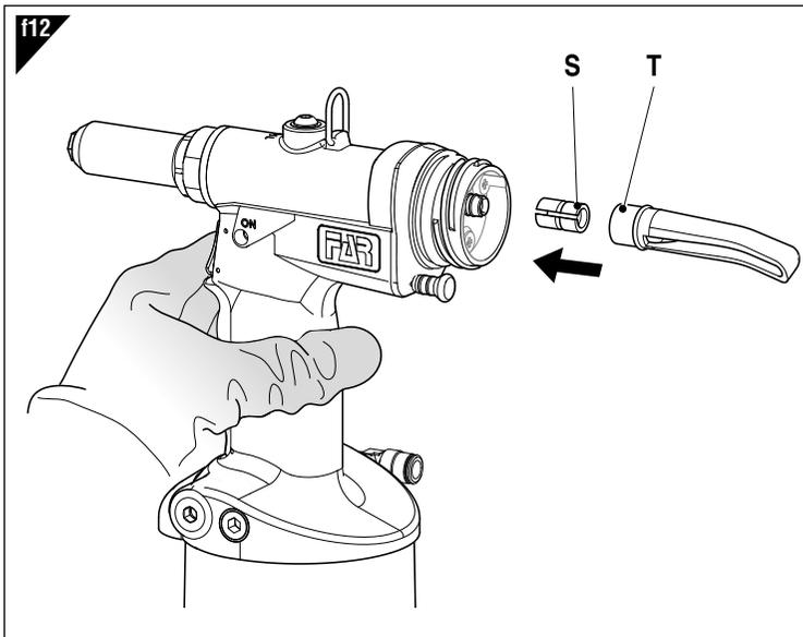
Si quieren convayar los vástagos cortados en un contenedor, sacar el desviador vástago (T) de la herramienta y la reducción relacionada (S). Conectar la remachadora con un tubo  $\varnothing 10 \times 8$  (C) con su inserción en el empalme. PRECAUCIÓN: el radio de curvatura del tubo no debe ser inferior a 300 mm, como se encuentra en la (fig. f14).
