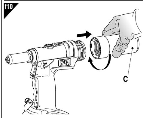
Per l'assemblaggio del deflettore (T) procedere come segue: rimossa il contenitore chiodi (C) (fig. f10), rimuovere il coperchio (R), montare la riduzione (S) sul raccordo e con una leggera pressione inserire il deflettore (T).
