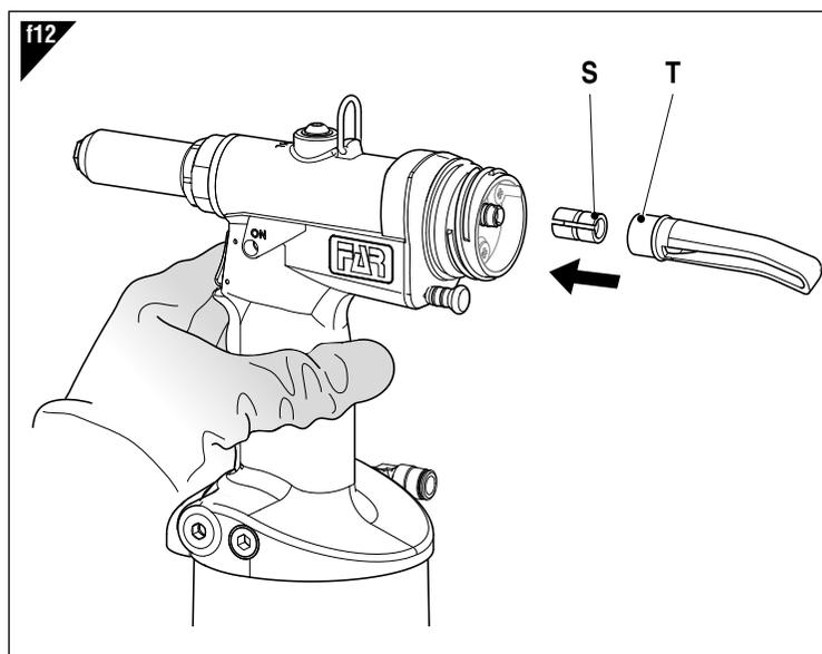
W przypadku konieczności odprowadzenia uciętych gwoździ do pojemnika, zdemontować z nitownicy osłonę zatrzymującą gwoździ (T) oraz redukcję (S). Podłączyć do nitownicy przewód rurowy  $\varnothing 10 \times 8$  (C), nasuwając go na złączkę.
