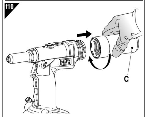
Para el montaje del deflector (T) proceder como sigue: eliminar el colector de vástagos (C) (Fig. f10) y el tapon (R), montar la reducción (S) sobre el conector y insertar el deflector (T) con una ligera presión.
