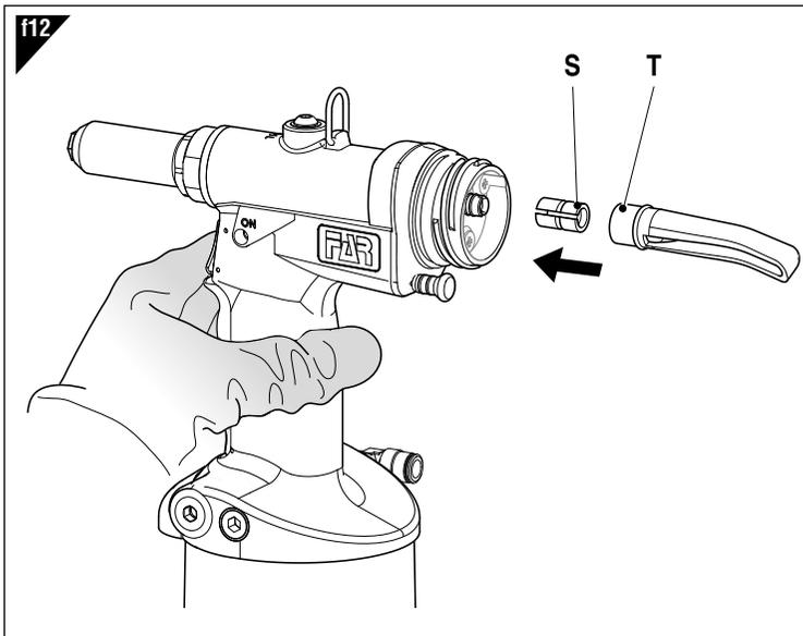
Wollte man die abgetrennten Nietdorne in einem Container transportieren, entfernen Sie von dem Nietwerkzeug den Ablenker für Nägel (T) und die relative Reduktion (S).
