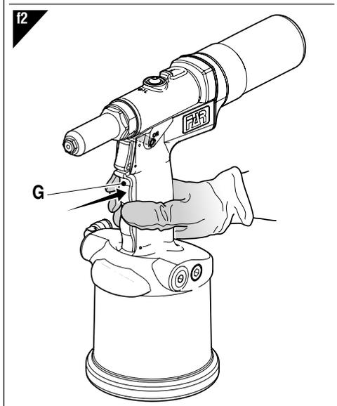
Отсос запускается при нажатии рычажка (G), как показано на рисунке (рис. f2).
