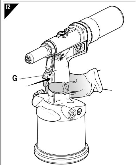
Zasysanie uruchamiane jest po naciśnięciu dźwigni (G), zgodnie ze wskazaniami na rysunku (rys. f2).
