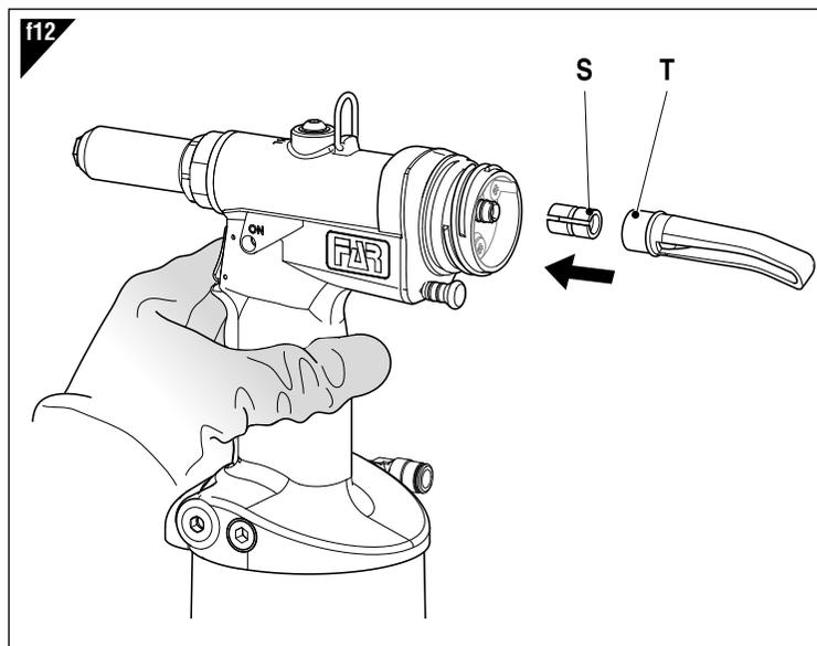
Если потребуется снова установить приёмник для хвостовиков, необходимо снять отбойник (Т) и соответствующий переходник (S).
