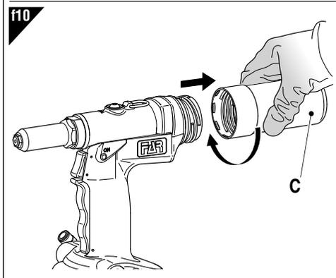
Порядок установки отбойника (Т) следующий: после снятия приёмника хвостовиков (С) (рис. f10) снимите крышку (R), установите переходник (S) на штуцер лёгким нажимом и затем подсоедините отбойник (Т).
