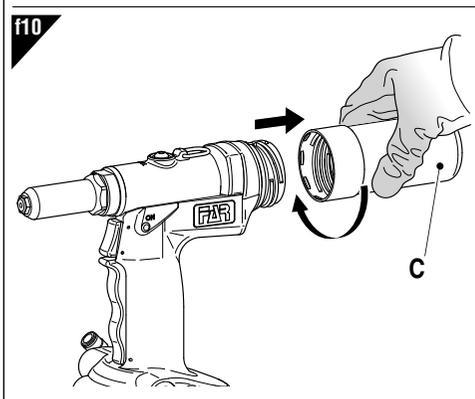
Aby zamontować osłonę zatrzymującą gwóźdź (T), stosować się do następującej procedury: po zdemontowaniu pojemnika na gwoździe (C) (rys. f10), zdemontować pokrywę (R) i zamontować redukcję (S) na złączce; wsunąć osłonę zatrzymującą gwóźdź (T), wywierając lekki nacisk.
