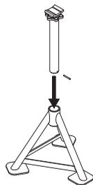
3. Kontrollera att pelaren därefter är förankrad och ej kan dras ut ur stativet.
