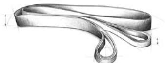
**Sangle de crochet (fournie) :** Utilisez la sangle pour tenir le crochet du câble tout en gardant les doigts éloignés du guide-câble pendant l'actionnement du câble. Le treuil par forage peut développer une force énorme et facilement arracher des doigts ou un membre malencontreusement pris dans le câble. Mettez la sangle du crochet dans la boucle du crochet et tenez la sangle entre le pouce et l'index.
