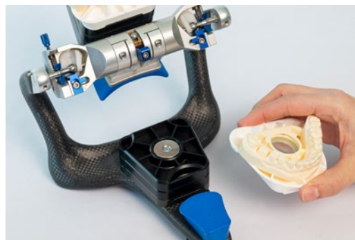
Fig. 12: Inserção da placa base do modelo com o modelo no articulador Artex
