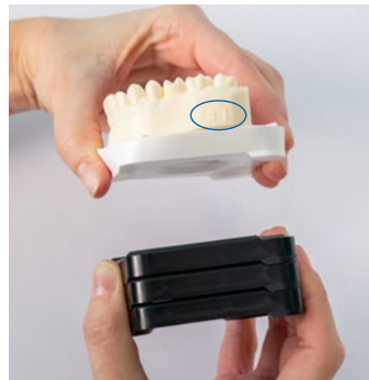
Fig. 10: Fijación de la placa base del modelo a las placas distanciadoras
