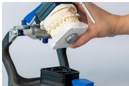
Abb. 17: Standardmagnettopf mit Splitex-Konterplatte
