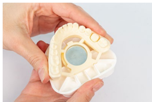
Fig. 16: Stacco del modello dalla piastra di base del modello
