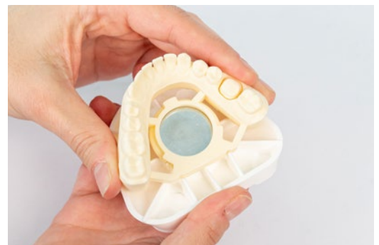
Fig. 16: Separación del modelo de la placa base del modelo
