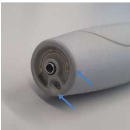
Bild 9: Illustration av spraykanalen och LED-belysningen på det kompakta handstycket
