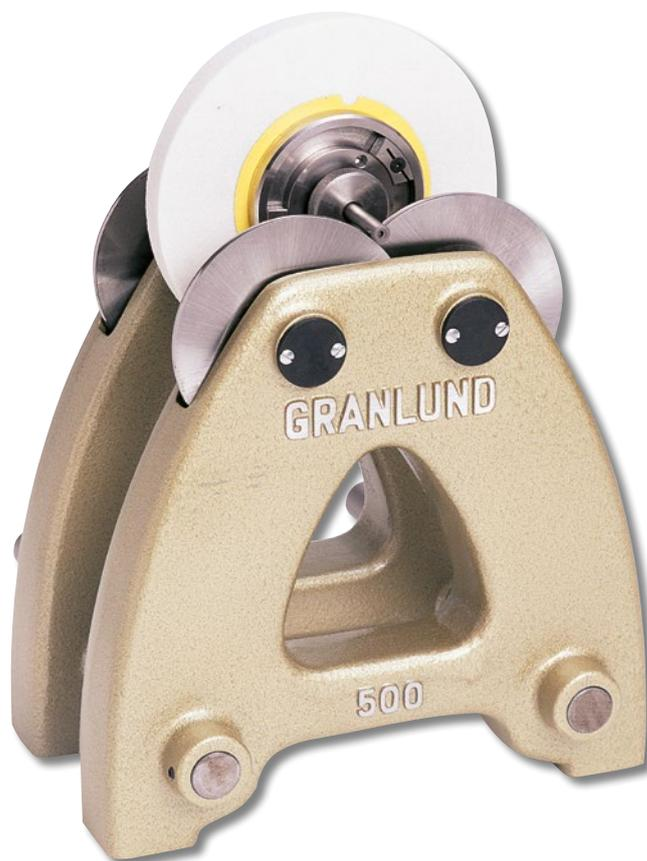
L'équilibreuse statique Granlund est conçue avec des roulements à bille de précision, des flasques d'équilibrage rectifiées et en acier traité.
