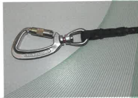
Bild 6: Endverbindung mit Triplelock Karabiner und Wirbel/Indikator
