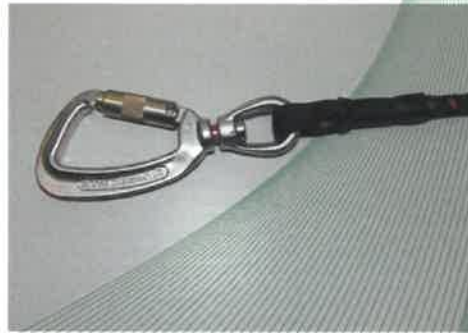
Bild 9: Endverbindung mit Triplelock Karabiner und Wirbel/Indikator
