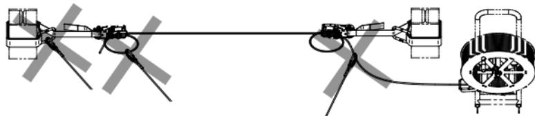
Die Befestigung am System erfolgt lediglich am horizontal gespannten original Ø 8 mm Edelstahlseil. Eine Befestigung an Gurtband, Ratsche, etc. stellt ein Sicherheitsrisiko dar und ist untersagt!
