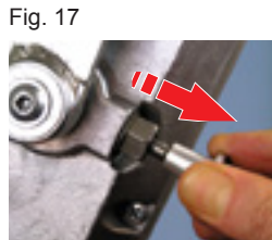
Figure 16 / 19 montre: L'antichute à rappel automatique IKAR avec la position de la manivelle en fonctionnement sur l'antichute à rappel automatique
