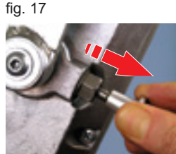
Fig. 16/19 viser IKAR-faldsikring HRA med håndsvinget i funktionsstillingen "faldsikring"!
