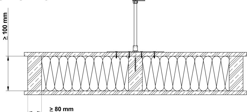
**O B S ! Träskruvarna 8x120 får endast sättas in i konstruktionsvirke!**
