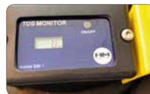
När TDS-mätaren visar 10 är det dags att byta filter (efter ca 4000 liter vatten)
