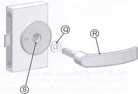
Infilare la rondella (Q) sul perno maniglia (R) e inserirlo nel foro (S) della serratura fino a far appoggiare la maniglia contro la rosetta.
