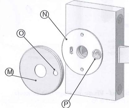
Posizionare la rosetta esterna (M) sul bordo della bocchetta esterna (N) orientando il foro di sicurezza (O) sul foro di sicurezza della bocchetta (P). Bloccarla la rosetta applicando una leggera pressione.
