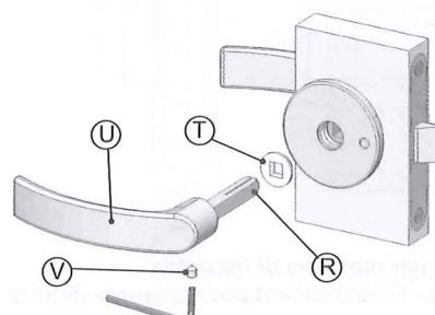
Infilare la rondella (T) e la maniglia (U), sul perno quadro (R) uscente dalla serratura. Compattare la maniglia una contro l'altra e stringere il grano M5 (V).
