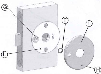
Calzare l'O-rings (F) sulla sede del perno di blocco (G). Allineare il foro (H) della rosetta interna (I) con il foro del perno di blocco (G), posizionare la rosetta sul bordo della bocchetta (L) e bloccarla applicando una leggera pressione.
