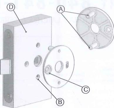
Inserire i cannelli della bocchetta interna (A) negli appositi fori (B) facendo attenzione al foro per il perno (C), fino a far appoggiare la bocchetta sulla superficie della porta (D). Fissare la bocchetta interna con quella esterna mediante le viti (E).
