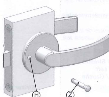
Inserire il Perno di blocco (Z) nel foro (H) dal lato esterno della porta , fino in fondo alla serratura.
