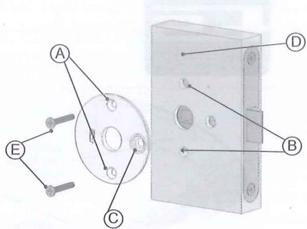
Inserire i cannelli della bocchetta interna (A) negli appositi fori (B) facendo attenzione al foro per il perno (C), fino a far appoggiare la bocchetta sulla superficie della porta (D). Fissare la bocchetta interna con quella esterna mediante le viti (E).
