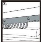
2. Käytä yhtä sormea ja paina / taivuta niin, että vapaat metallilievysormet täyttävät kansilevyihin päin olevat tilat.
