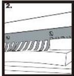
2. Använd ett finger och tryck/bøj så att de fria plåtfingrarna fyller ut i mellanrummen mot lockbrädorna.
