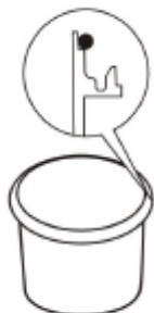
Korrekt placering af o-ring / Korrekt placering av o-ring
