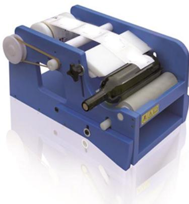
MATERIALE DI COSTRUZIONE: Polietilene tipo PE500
