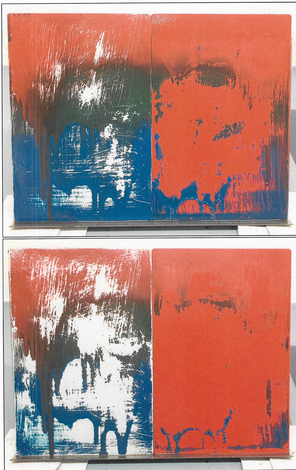
Abbildung 4: Probeplatten nach 10 min Einwirkzeit abgezogen (oben) und angepaddet (unten)
