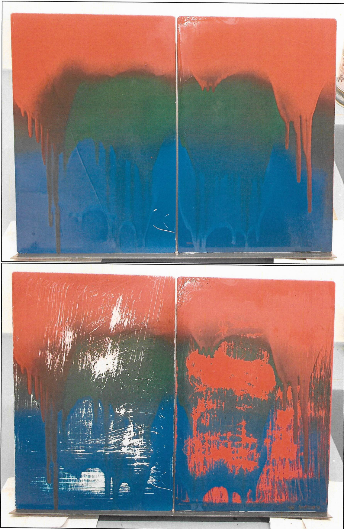
Abbildung 3: Probplatten nach 5 min Einwirkzeit abgezogen (oben) und angepaddet (unten)
