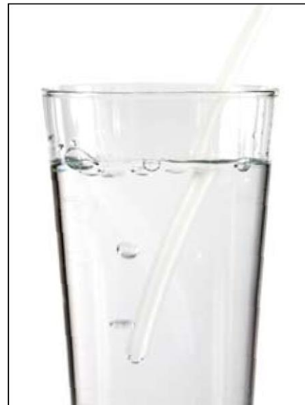
Håll ner slangen i ett glas med vatten. Vrid på sidokranen hatten, motsols(!) till det kommer rätt antal bubblor.
