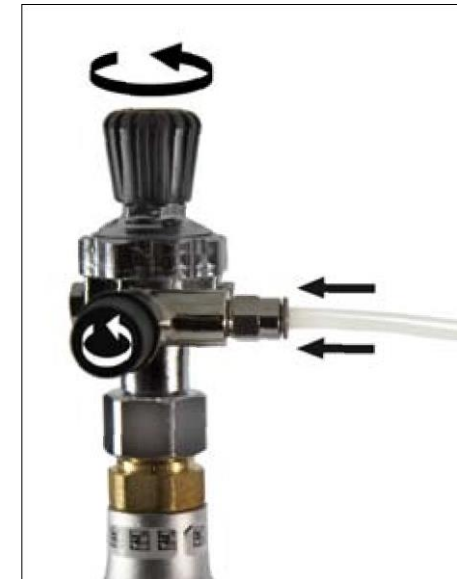
Tryck på slangen. Öppna toppventilen helt och hållet (obs: medsols), och vrid tillbaka den ett 1/4 varv.
