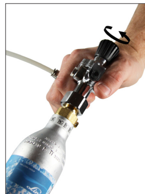
Skruva på regulatören på flaskan (med handkraft) tills luften "pyser till", skruva vidare till det blir tyst.
