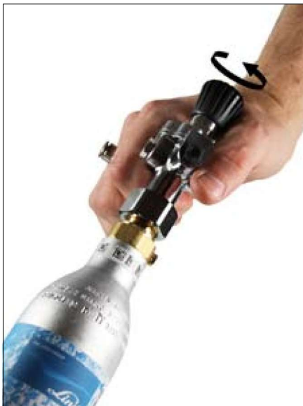
Skruva på regulatorn på flaskan (med handkraft) tills luften "pyser till", skruva vidare till det blir tyst.
