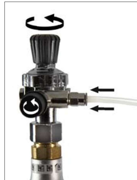
Tryck på slangens. Öppna toppventilen helt och hållet (obs: medsols), och vrid tillbaka den ett 1/4 varv.
