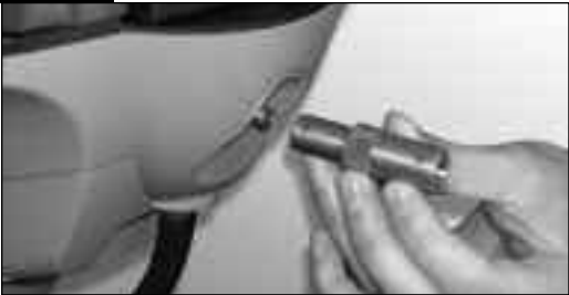
Kierrä ensin Quick Clear –sovitin venttiiliin käsin.
