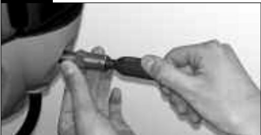
Aloita puhdistus kiertämällä patruunaa auki vain neljänneskierros pitäen sovitinta paikoillaan.
