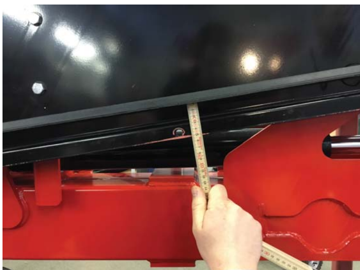
Fig1 Pos3. Remmen som kommer ifrån traktorn skall spännas så att den trycks ner 1cm av 11kg kraft mitt emellan remskivorna.
