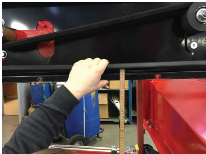
Fig1 Pos4. Remmen till kättinghuvudet (med spännrulle) skall spännas så att den trycks ner 1cm av 7kg kraft mitt emellan remskivorna.
