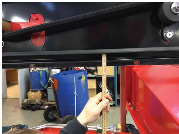
Fig1 Pos4. Remmen till kättinghuvudet (med spännrulle) skall spännas så att den trycks ner 1cm av 7kg kraft mitt emellan remskivorna.
