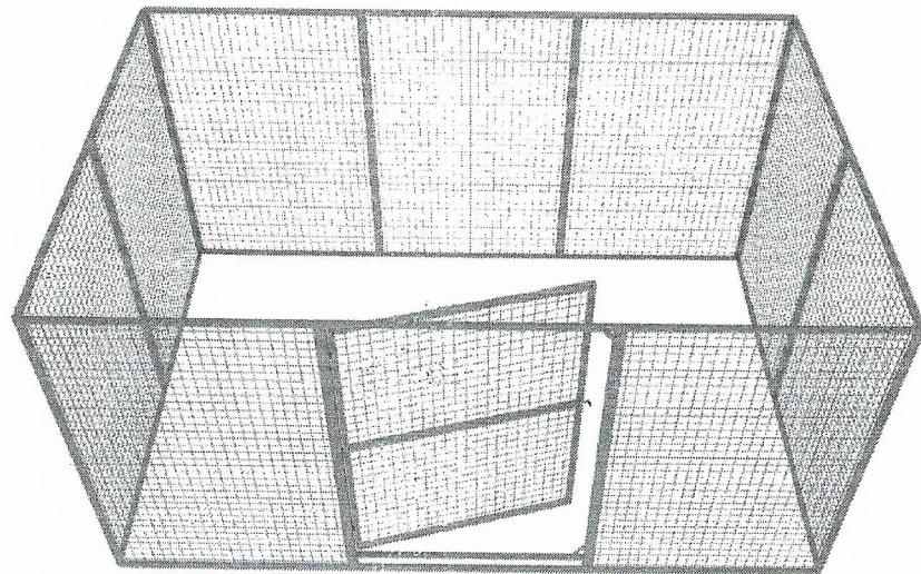
1. Placera ut träreglar som underlag för hundgårdens väggar. Lämpligt virke kan vara 45x70mm tryckimpregnerat. Åtgång 1,2 m/sektion. Res två sektioner som skall bilda hörn och sammanfoga med 2st Bultar M6x60mm med tillhörande brickor samt mutter.
