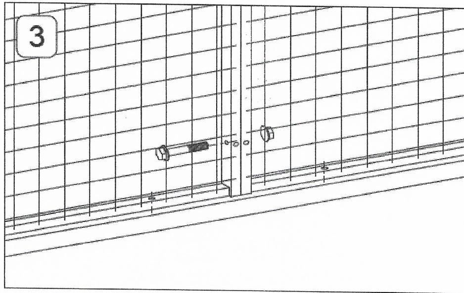
4. Avsluta monteringen med att förankra sektionerna i träreglarna. Använd de medföljande franskaträskruvarna, 2st/sektion. Sätt dit de svarta täckproparna i varje sektions profilrör
