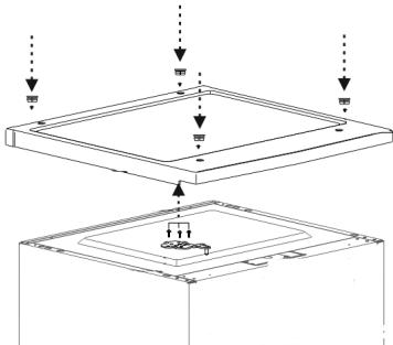
12.Sätt tillbaka apparatens lock, skruva fast det och sätt tillbaka skrulkåporna.
