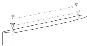
10. Richten Sie die Tür aus. Setzen Sie das obere Türgelenk mit dem Lagerzapfen in die Buchse an der Oberseite der Tür und schrauben Sie es fest.
