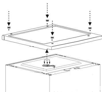
12. Setzen Sie den Gerätedeckel wieder auf, schrauben Sie ihn fest und setzen Sie die Schraubenabdeckungen wieder ein.
