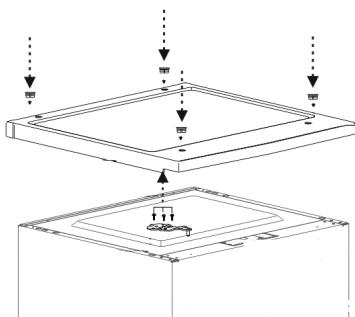
12. Riposizionare il coperchio sull'apparecchio, fissarlo saldamente e riposizionare i cappucci delle viti.
