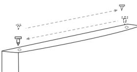
10. Ajuste la puerta. Inserte la bisagra superior de la puerta con el perno en el cojinete situado en la parte superior de la puerta y atorníllela.
