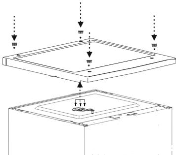
12. Nałożyć pokrywę urządzenia, przykręcić ją i założyć osłony śrub.
