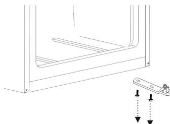
5. Allentare il bullone che fissa il perno alla cerniera inferiore e inserire nuovamente il perno con la rondella in un altro foro. Fissare il perno con il bullone.
