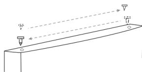
10. Allineare lo sportello. Applicare la cerniera superiore con il cuscinetto di banco nella boccola sul lato superiore dello sportello e avvitarla saldamente.
