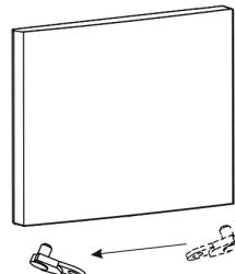
8. Setzen Sie die Gerätetür auf den Lagerzapfen des unteren Türgelenks und drücken Sie sie leicht an das Gerät.
