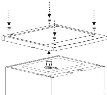
12. Vuelva a colocar la tapa del aparato, atorníllela bien y vuelva a colocar las tapas de los tornillos.
