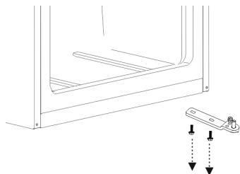
5. Desserrez l'écrou qui fixe la tige à la charnière inférieure et replacez la tige avec la rondelle dans l'autre trou. Fixez la tige avec l'écrou.
