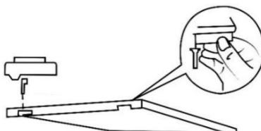
3. Inclinez légèrement l'appareil vers l'arrière et dévissez les pieds réglables avant de l'appareil.
