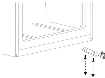
5. Lösen Sie die Mutter die den Stift am unteren Türgelenk fixiert und setzen Sie den Stift mit Unterlegscheibe im anderen Loch wieder ein. Fixieren Sie den Stift mit der Mutter.
