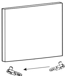
8. Plaats de deur van het apparaat op het draapunt van het onderste deurscharnier en druk haar lichtjes tegen het apparaat.
