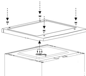
12. Plaats het deksel van het apparaat terug, schroef het vast en plaats de schroefafsluitingen terug.
