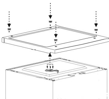
12. Remettez le couvercle de l'appareil, vissez-le et remettez les fixations des vis.
