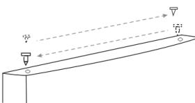
10. Wyregulować drzwi. Umieścić górny zawias drzwi z czopem łożyskowym w tulei na górnej części drzwi i mocno go przykręcić.
