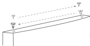
10. Richt de deur uit. Plaats het bovenste deurscharnier met de lagerpen in de mof aan de bovenzijde van de deur en schroef deze vast.
