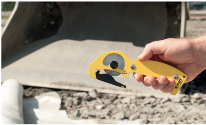
På byggarbetsplatser för att skära markduk m m.
