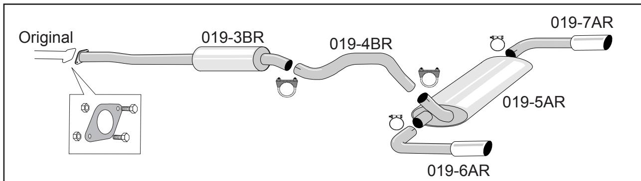
Avgassystemet skall monteras i bilens original upphängningspunkter på samma sätt som originalsystemet.
