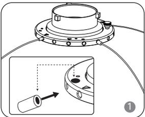
红点标识支撑杆插入对应红点卡盘孔，对称安装所有支撑杆。
