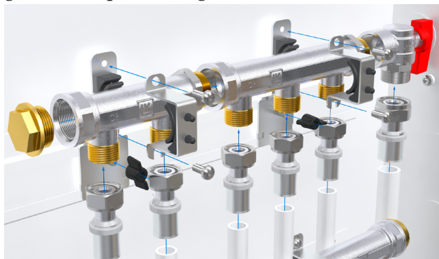
Montering av fördelare
