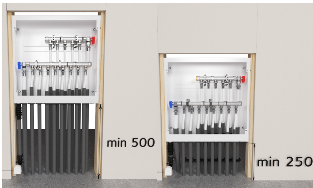
Exempel montagehöjd utan och med fixeringsplatta.
