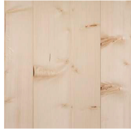
Utslag i och runt kvist. Sprickor i yta.
