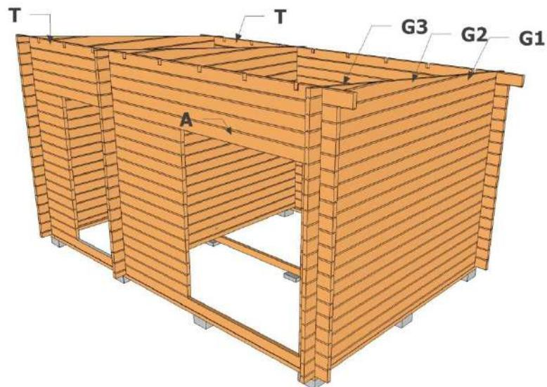
Lägg i takåsarna i urtagen på i T-brädorna. Det längre takutsticket ska vara mot framsidan. De två yttre takåsarna utan urtag skruvas längst ut i T-brädorna.
