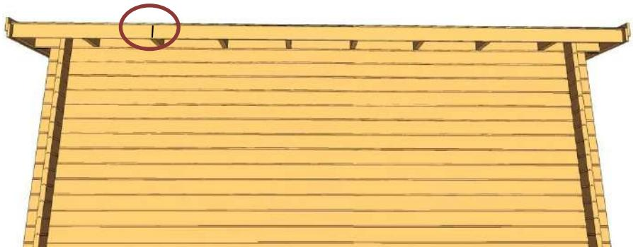
Kapa till de övre takfotsbrädorna. Dessa ska monteras med överkant jäms med taket. Skruva i nedre takfotsbräden och i takbrädorna.
