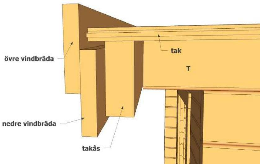
Mäta och kapa till de nedre takfotsbrädorna. De monteras jäms med underkant på de nedre vindbrädorna. Skruva i takåsarna.
