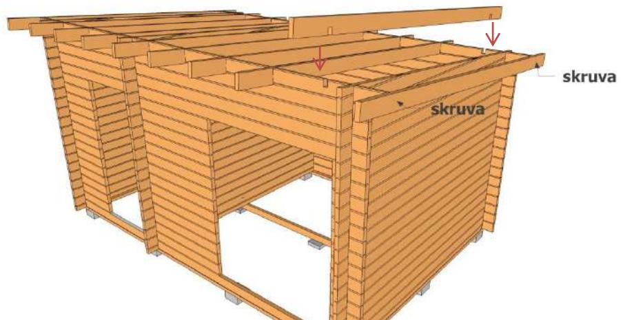
Montera taket. Lägg brädorna med finsidan inåt.
